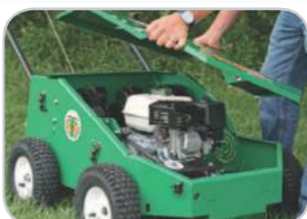
Werkzeugloses entfernen der Abdeckung für Wartungsarbeiten
