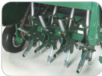
Aerifizieren mit gehärteten Hohlzinken.
