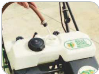
Wassertank als Zusatzgewicht von 25 kg bei AE 401 H.
