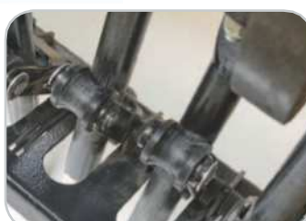
Laufbuchsenführungen für präzise Einstiche der Hohlzinken
